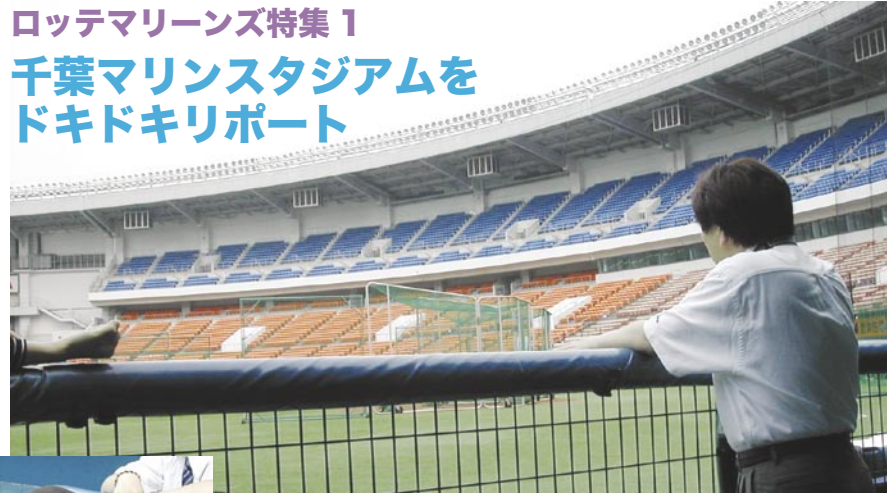
■ グランド 人工芝は毛足が長く、本物に近い感触。下のゴムに小さな穴が空いており水はけをよくしている。マウンドとベースの土は、スパイクのかりがいい「荒木田土」にオレンジ色のアンツーカーを混ぜ、太陽の反射を防いでいる(白い土だと反射してまぶしい)。 現在、最前列席を移動してサッカーなどができる設計になっているが、内野席前にフィールドシートというかぶりつきの席を作る予定だとか。
